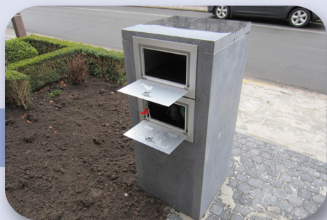
Boîte aux lettres avec accès séparé du courrier et du tuyau de remplissage
